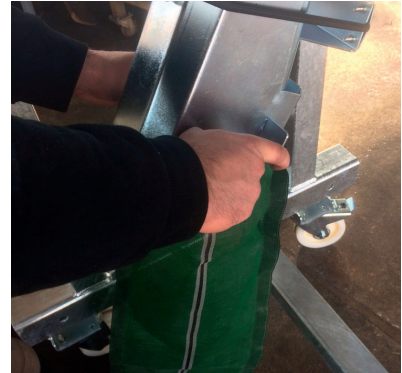
Abfüllmischer AFM 150 2S ermöglicht schnelles Befüllen von Sandsäcken
